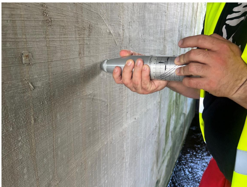
Zdj. 6 Badania nieniszczące przy użyciu młotka Schmidta typu N.
